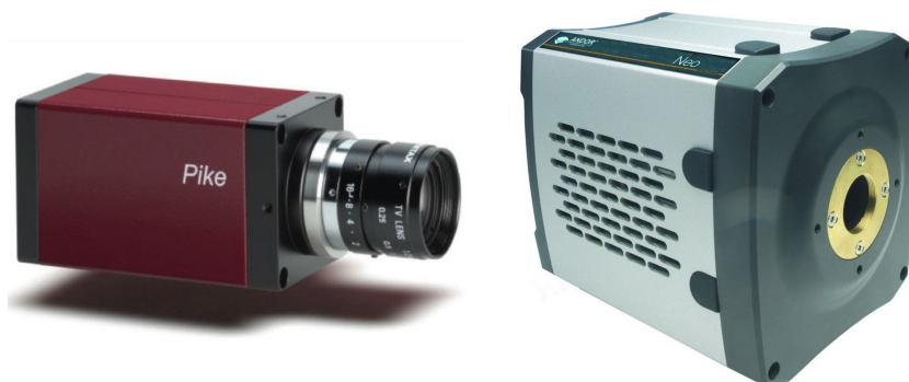
FIGURE 5.10 – Images des deux détecteurs utilisés sur le banc THD. À gauche la Pike et à droite la NEO.
